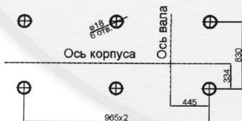
Схема расположения отверстий под фундаментные болты
